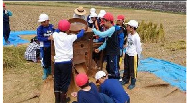
とうみも使わせていただきました。風の力を利用して、籾に混ざっている葉や藁くずを分別します。この仕組みもコンバインには入っています。
